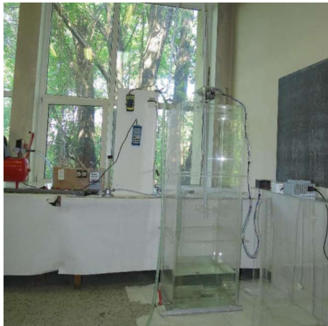
Fig. 4.18. Instalația de oxigenare a apelor cu G.B.F. aflat în mișcare de rotație
