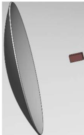
Fig. 3.15. Colector cu oglindă parabolică discoidală[3.38]
