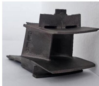
Figura 1. Paleta de stator a turbinei motorului Allison model T56-A-15, care echipază aeronavele C130 Hercules.
