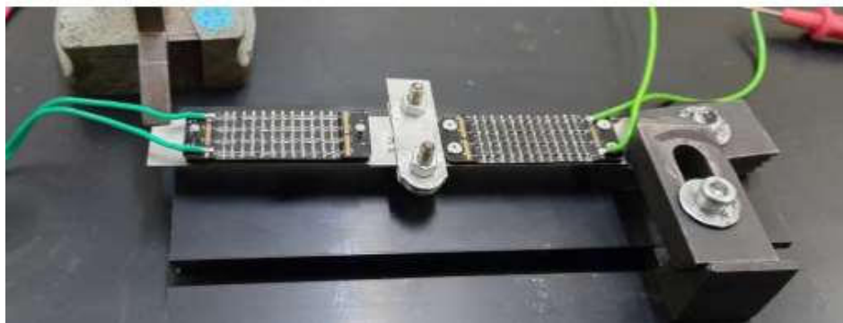
Fig. 8. Vedere a unui montaj în serie a două actuatore aliaje cu memoria formei achiziționate de la firma CompActive
