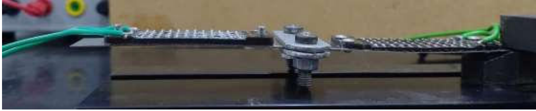
Fig. 9. Vedere a unui montaj în serie a două actuatoare aliaje cu memoria formei achiziționate de la firma CompActive
