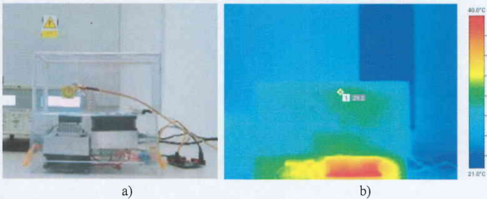
Figura 22. Stand de testare: a)imagine vizuală, b)imagine termală.
