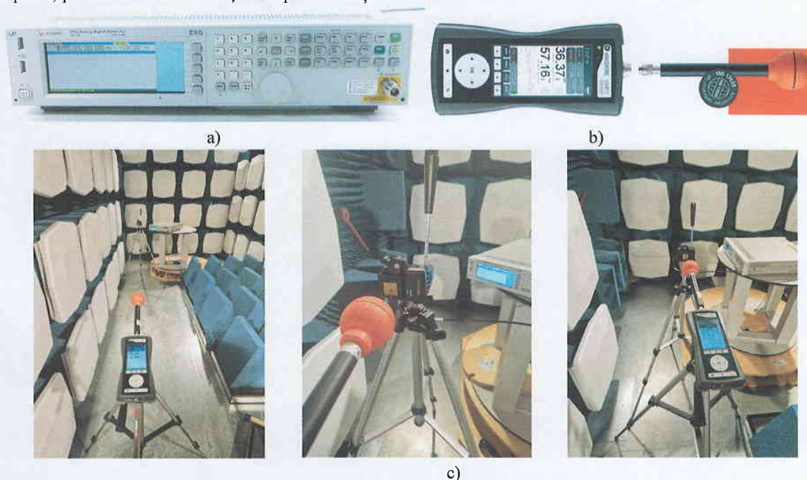
Figura 3. Standul de testare pentru determinarea intensității câmpului electric: a) generator de semnal, b) Electromagnetic Field Meter, c) stand de testare.
