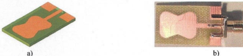
Figura 9. Structura finală care funcționează la 5 GHz: a)structura modelată numeric, b) structura realizată practic.
