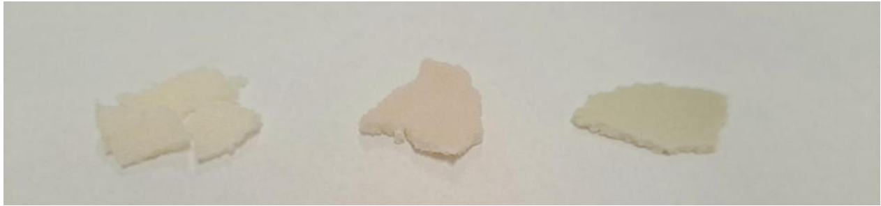
Figura 7. Hidrogelurile polimerice dopate cu AuBPs și AgNPs la pH 7 (Control - stânga, Hidrogel-AuBPs - centru, Hidrogel-AgNPs - dreapta).
