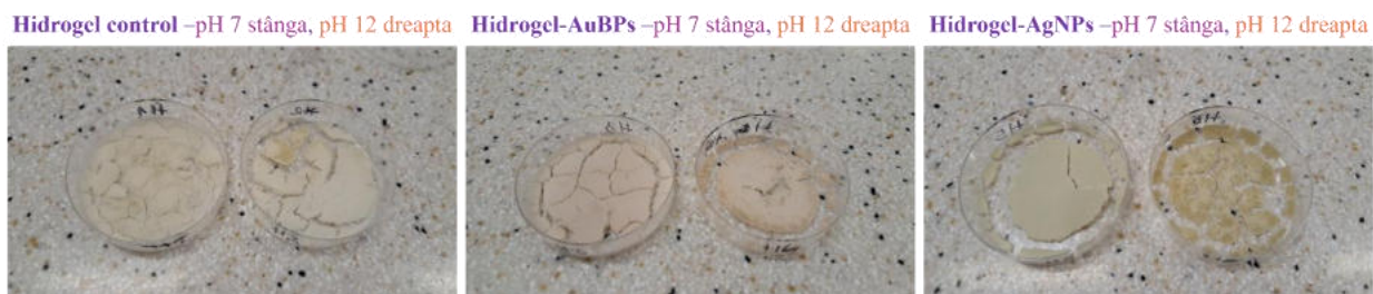
Figura 6. Hidrogelurile polimerice dopate cu AuBPs și AgNPs la pH 7 și pH 12.
