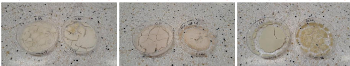
Hidrogel control –pH 7 stânga, pH 12 dreapta Hidrogel-AuBPs –pH 7 stânga, pH 12 dreapta Hidrogel-AgNPs –pH 7 stânga, pH 12 dreapta
