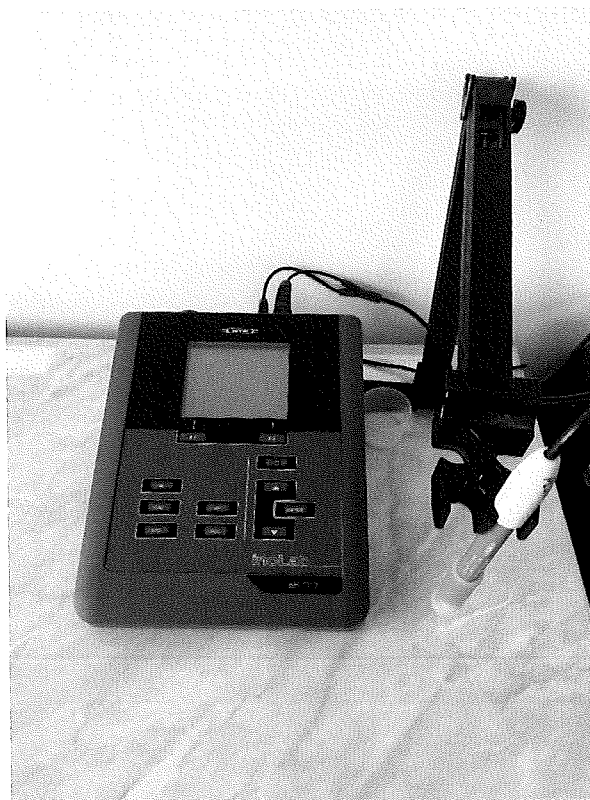
Figura 5. pH-metrul WTW 7310, cu electrod din sticlă WTW SenTix41, folosit pentru determinarea pH-ului soluțiilor de extract F_1 - F_5
