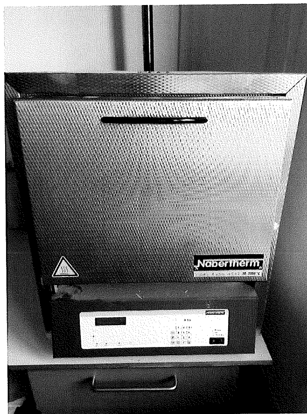
Figura 4. Cuptorul de calcinare Nabertherm L9/11/B410, folosit pentru determinarea conținutului de substanțe minerale din nămol
