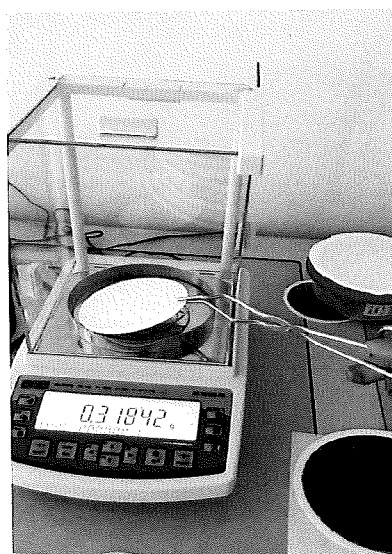
Fig. 10 Manipularea filtrelor cu ajutorul pensetei
