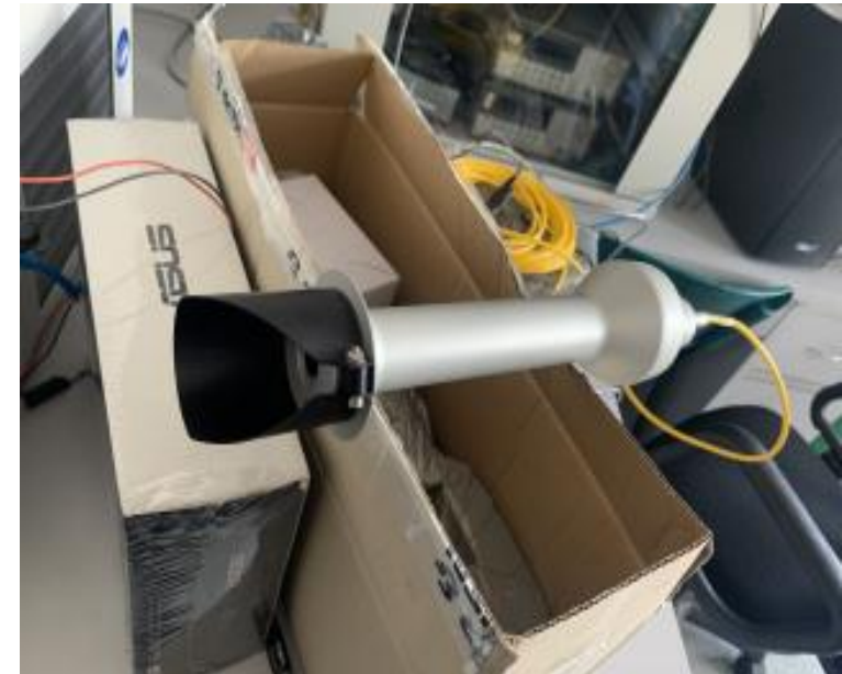
Fig. 5. Pirheliometru Kipp & Zonen SHP1, achiziție nouă [original].
