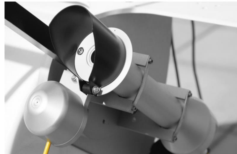
Fig. 5. Pirheliometru Kipp & Zonen SHP1 [2].
