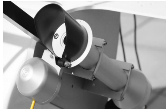
Fig. 3. Pirheliometru Kipp & Zonen SHP1 [15].
