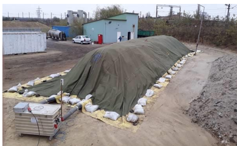
Figura 1. Sistem inchis cu membrana semipermeabila si aerare fortata util-metoda GORE™ COVER
