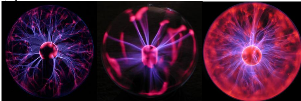
Figura 5. Lampă cu plasmă (Culorile se datorează relaxării electronilor din stări excitate în stări
