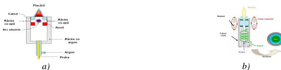
Figura 6. Părți componente ale torțelor utilizate în AES: a. torță cu arc electric; b. torță cu plasmă cuplată inductiv (ICP).
