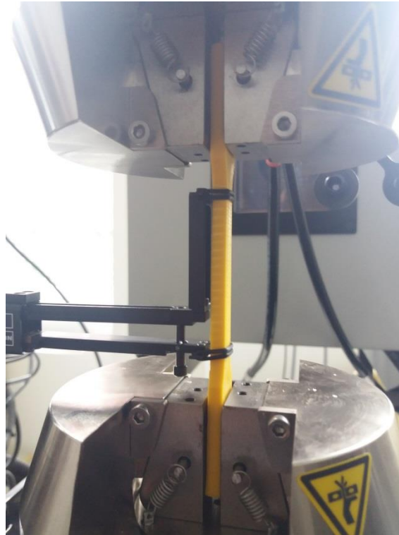
Fig. 8 Extensometrul prins de epruvetă în timpul testării
