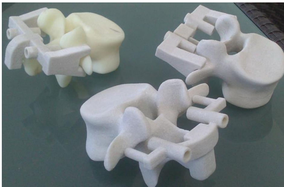
Fig.31 Modele de obiecte fabricate prin procedeul FDM
