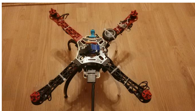
Fig. 3 Drona folosită de noi și inspirată de modelul DJI F450.
