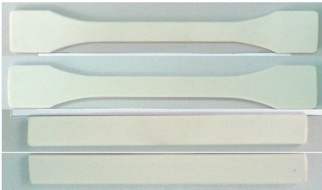
Fig. 3. Epruvete de testare prelucrate prin extrudare / injecție (aceeași procedură folosită pentru produse finite utilizat direct la nivel industria) care au fost supuse procesului de reciclare
