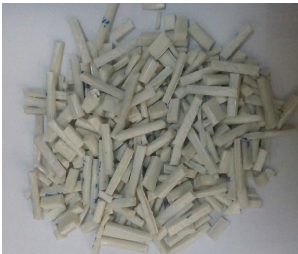
Fig. 5. Fragmentele de PA6 după tăierea specimenelor de testare, utilizând cuțite tehnologice
