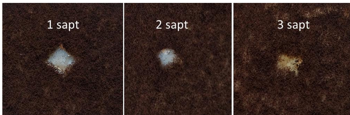
Figura 21. Aspectului culturilor de A.niger dezvoltate in prezenta membranelor nanostructurate de PET@ZnO, debit 5mL/h, timp de 1, 2 sau 3 saptamani.
