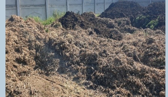
Omogenizarea amestecului înainte de amplasarea acestuia peste țevile de aerare
