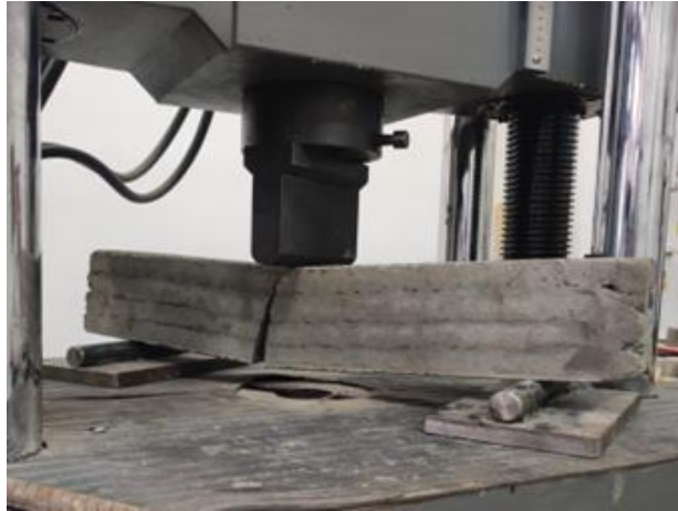
Încercarea la încovoiere în 3 puncte
