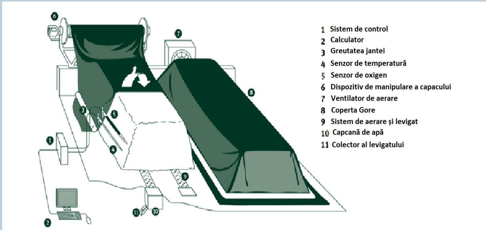
Sistem GORETM COVER utilizat în compostarea nămolului
