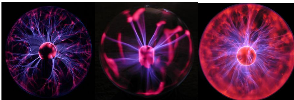
Figura 2. 2. Lampă cu plasmă (Culorile se datorează relaxării electronilor din stări excitate în stări cu energie mai mică. Spectrul emis este caracteristic gazului ionizat).
